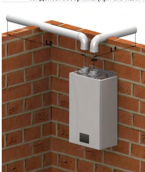
Рис. 5 Схемы присоединения раздельного дымохода Ø 80 мм к котлу и установка диафрагмы
