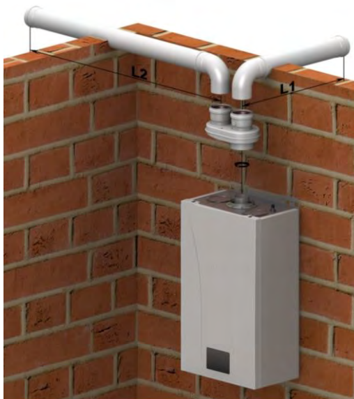
Рис. 5 Схемы присоединения раздельного дымохода Ø 80 мм к котлу и установка диафрагмы
